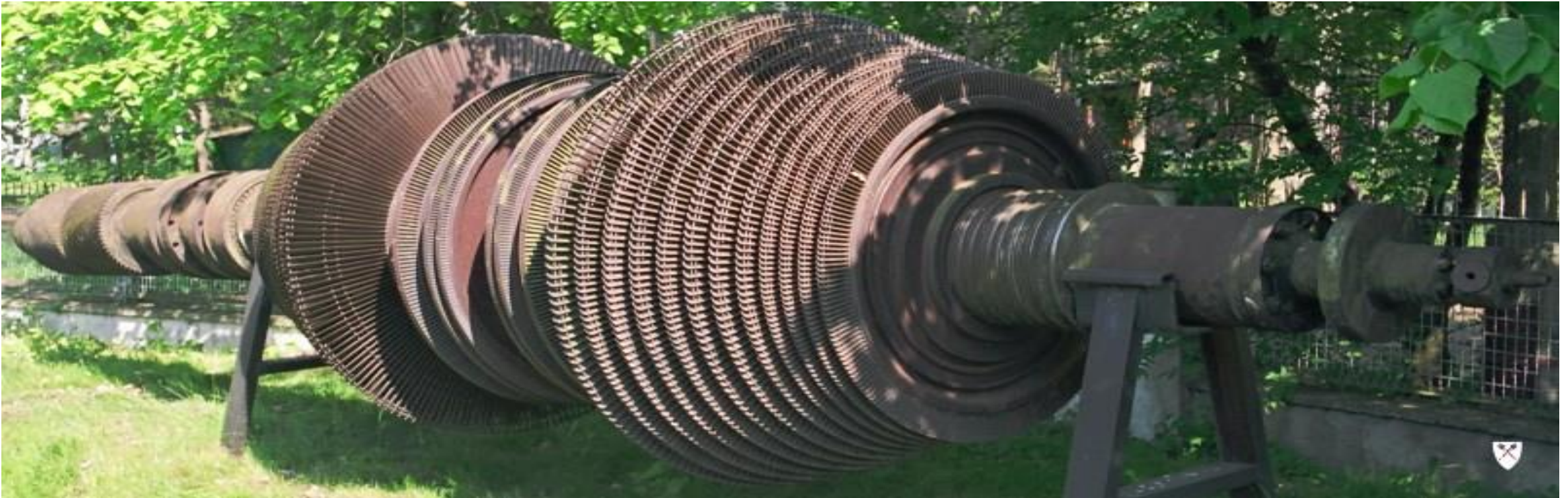
Wirnik turbiny parowej Parsonsa z ORP Wicher
