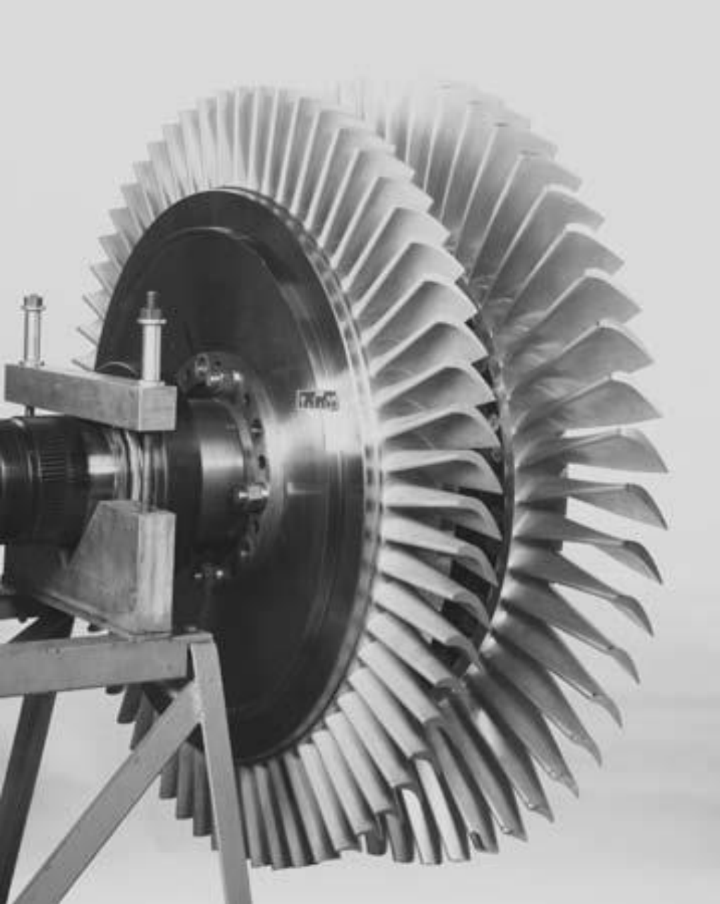
Tarcze wirnikowe turbiny parowej
