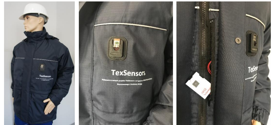
Widok kurtki roboczej z wymiennym sensorem gazu i układem elektronicznym
