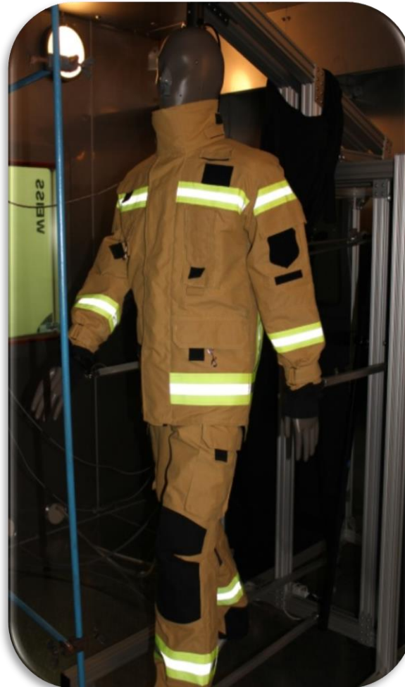
Stanowisko do badania sensoryczności na bodziec termiczny
