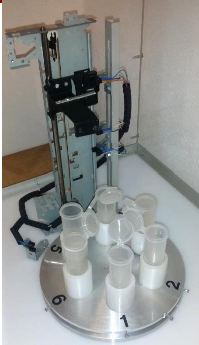
Urządzenie do nanoszenia cienkich warstw z wykorzystaniem PLC
