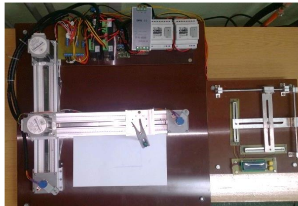
Układ odwzorujący ruch z wykorzystaniem Arduino
